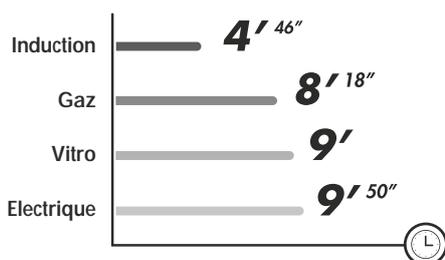
Test du temps nécessaire pour faire passer 2 litres d'eau de 22°C à 99°C. Les résultats peuvent changer en fonction de la typologie, de la dimension des casseroles et de la zone de cuisson utilisée.
